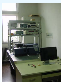
图 1.电致发光、光致发光、I-V, L-I-V 综合自动测量系统
