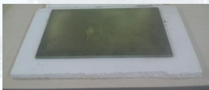
图17. 烧结后靶材材料照片。
