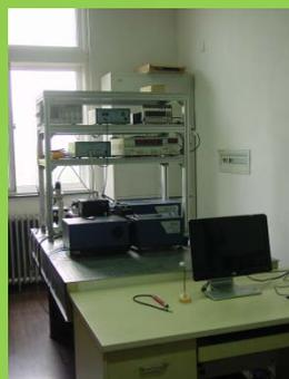
图 1.电致发光、光致发光、I-V, L-I-V 综合自动测量系统
