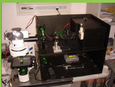
图 3 显微拉曼光谱仪样机
